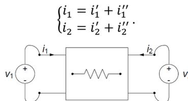
Le intensità  $i_1'$  e  $i_2'$  sono quelle che si avrebbero se fosse  $v_2 = 0$ , mentre  $i_1''$  e  $i_2''$  sono quelle che si avrebbero se fosse  $v_1 = 0$ .
