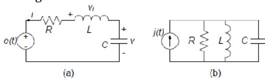
Entrambi sono costituiti da un induttore, un condensatore ed un resistore lineari e tempo invarianti; ciascuno è poi forzato da un generatore, in un caso di tensione, nell'altro di corrente. Essi sono fra i circuiti del secondo ordine più semplici che si possa considerare e al contempo completi dal punto di vista del comportamento dinamico. Il circuito (a) prende il nome di circuito  $RLC$  serie e il circuito (b) prende il nome di  $RLC$  parallelo.
