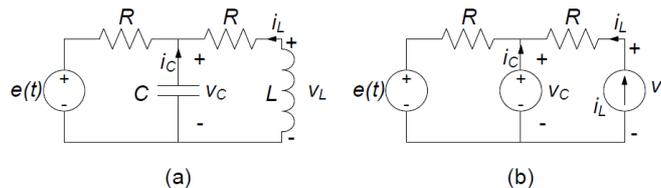
Esso è un circuito *RLC* del secondo ordine con un generatore indipendente di tensione; i resistori, il condensatore e l'induttore sono tempo-invarianti. L'estensione dei risultati che otterremo a situazioni più generali non presenta alcuna difficoltà.
