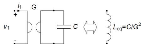
alla porta "2" del giratore è connesso un condensatore lineare tempo-invariante con capacità  $C$ . In questo caso si ha:
