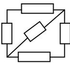
Per scrivere le equazioni di Kirchhoff per un determinato circuito è sufficiente riferirsi ad una struttura astratta che rappresenti i nodi del circuito e i collegamenti tra essi realizzati tramite i bipoli.
