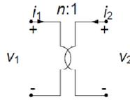
Sostituendo nell'espressione della potenza le relazioni caratteristiche sopracitate, la potenza elettrica assorbita dal trasformatore ideale è uguale a zero, in qualsiasi condizione di funzionamento. Esso è dunque un doppio bipolo globalmente passivo che non dissipa né immagazzina energia, cioè è *trasparente alla potenza*.
