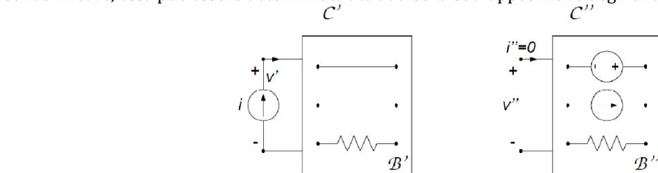
A tale scopo si considerino due *circuiti ausiliari*: il primo circuito  $C'$  è stato ottenuto spegnendo nel circuito  $B$  di fig. 4.33 tutti i generatori indipendenti di  $B$ , mentre il secondo,  $C''$ , è stato ottenuto spegnendo solo il generatore di corrente di caratterizzazione.
