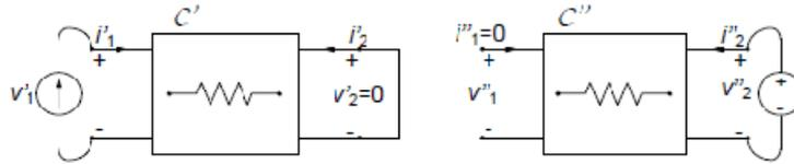
Per caratterizzare i parametri  $H$  possiamo fare riferimento ai due circuiti riportati in figura. Nel circuito  $C'$  la porta "2" è connessa ad un corto circuito,  $v_2 = 0$ , mentre nel circuito  $C''$  la porta "1" è collegata ad un circuito aperto,  $i_1 = 0$ .
