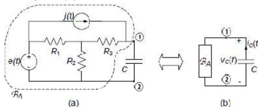
Esso è un circuito RC del primo ordine, costituito da un certo numero di elementi a-dinamici. In figura (b) la parte a-dinamica del circuito  $B_A$  è sostituita da un certo bipolo a-dinamico equivalente.
