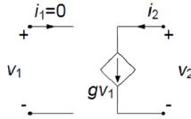
☞ **Generatore di corrente controllato in corrente**
