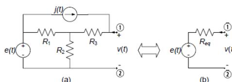
$e_0$  è la sua tensione a vuoto ed  $R_{Th}$  la resistenza equivalente di Thévenin, cioè la resistenza equivalente di  $B_A$  quando tutti i generatori ideali al suo interno sono spenti.
