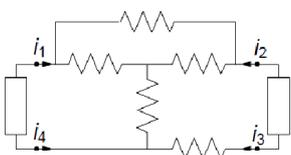
una tensione ed un'intensità di corrente. La prima porta designa la coppia di terminali da sinistra, cosicché la tensione e le intensità di corrente associate a questi terminali saranno marcate con il pedice "1"; analogamente la seconda porta designa la coppia di terminali di destra, sicché la tensione e la intensità di corrente associate a questi terminali saranno marcate con il pedice "2".
