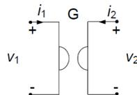
Anche per il giratore si può verificare che la potenza elettrica assorbita è uguale a zero in qualsiasi condizione di funzionamento, quindi esso è un bipolo globalmente passivo che né dissipa né immagazzina energia (*trasparente alla potenza*). Anche per questo bipolo non valgono le proprietà di non amplificazione.
