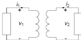
Può anche accadere che, pur non essendo possibile raggruppare naturalmente i quattro terminali di un elemento in due coppie, essi lo siano per come sono effettivamente collegati al resto del circuito in cui l'elemento è inserito. Se consideriamo il quadripolo rappresentato in figura qui a sinistra, osserviamo che le intensità di corrente verificano le condizioni:
