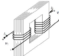
I due circuiti, primario e secondario, sono realizzati avvolgendo del filo conduttore su un supporto materiale fatto di ferrite o lamine sottili di acciaio speciale di elevata permeabilità magnetica<sup>6</sup>.
