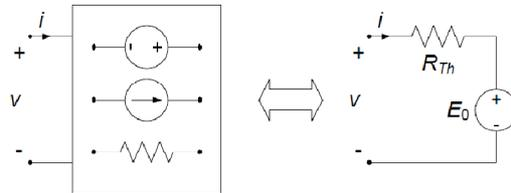
Ora realizziamo la caratterizzazione su base tensione del bipolo considerato. Supponiamo che il circuito in esame ammetta una ed una sola soluzione per ogni valore di tensione  $v$  del generatore di caratterizzazione ed applicando la sovrapposizione degli effetti come in precedenza, è semplice verificare che la relazione tra l'intensità di corrente  $i$  e la tensione  $v$  diviene:
