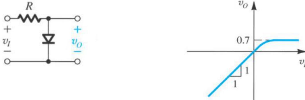
Quando la tensione di ingresso è negativa il diodo non conduce, quindi la corrente che passa per il diodo è zero, la caduta sulla  $R$  è zero, la tensione di uscita è uguale a quella di ingresso.
